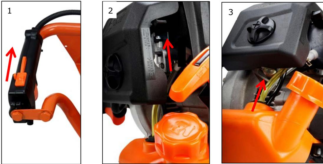
2. Coloque la palanca del ahogo (Choke) hacia arriba en "ARRANQUE EN FRÍO".
